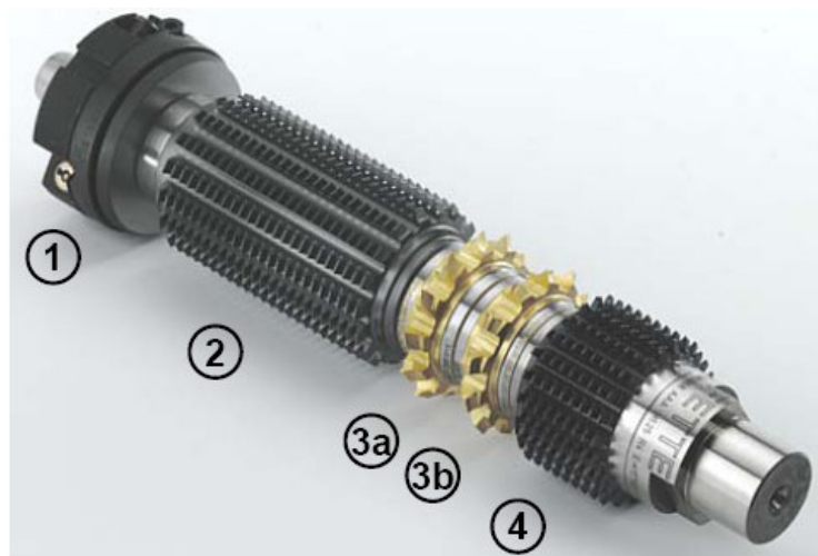
Figura N°2- Mandrino con creatori sgrossatore e finitore ed utensili smussatori montato su dentatrice Liebherr LC150
