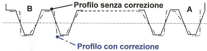
Figura N°5- Modifica continua del profilo dei denti del creatore lungo la sua lunghezza
